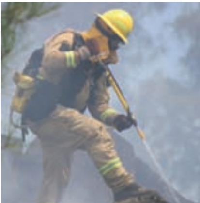
Abb. 6.4.1.1/3: Löschrucksack (Foto: @fire)
