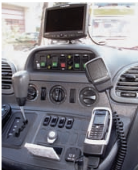
Abb. 1.4/1: Mobiltelefone z.B. in RD-Fahrzeugen mit beschränkter Nummernfreigabe, erfüllen die DIN EN 1789 und ermöglichen den Kontakt untereinander 1 und zu einer beschränkten Gruppe von Telefonen (z.B. Leitstelle, Krankenhäuser, spezielle Telefonnummern). (Foto: Cimolino)
